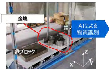
コンテナ中の密輸検知試験
