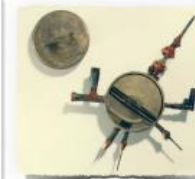
1932 by M. S. Livingston Proton: 80keV, 1kV
