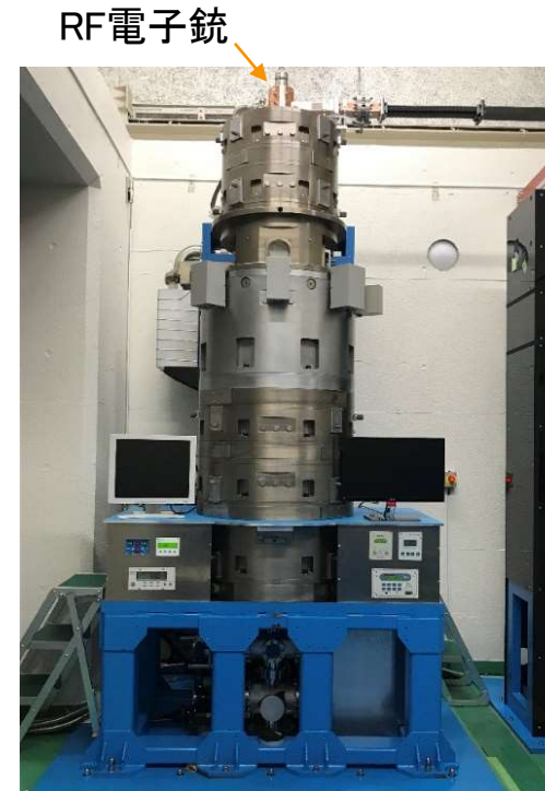
据付後の写真 3.5m(H)、0.8m(D)
