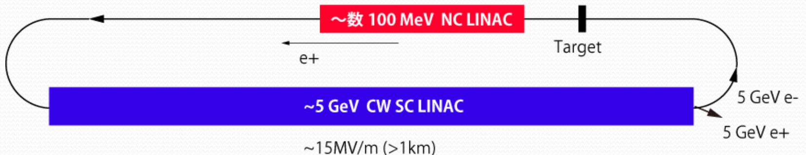
\*CW運転では、FCは超電導、前段加速器(常電導)は低い加速勾配で運転
